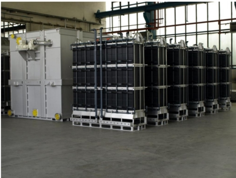
Abbildung 15b: getauchtes Membranmodul in externen Becken
