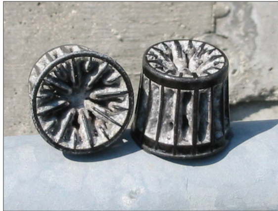
Abbildung 44: Bewachsene Biomasse-Träger aus betrieblichem Einsatz
